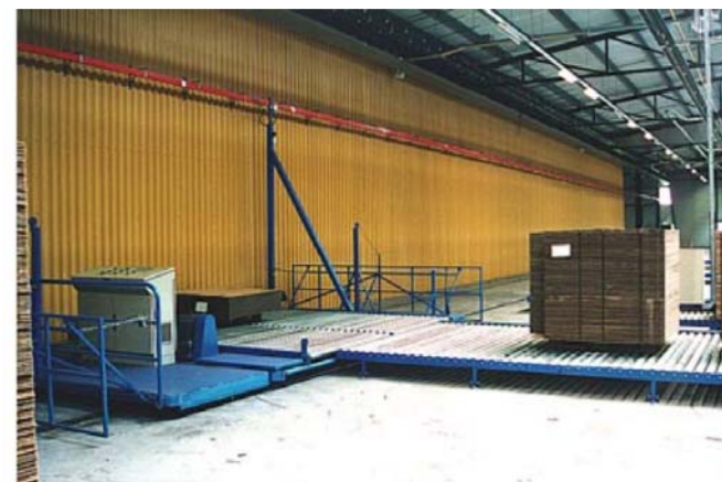
AKAPP Multiconductor, za napajanje i upravljanje jednog traverznog vozila u tvornici kartona
